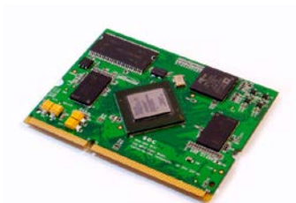
Fig. 3 SOC MPEG Codec Module
